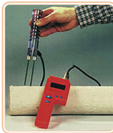
Figura 10.7: Medição do teor de umidade de uma madeira usando um ohmímetro
