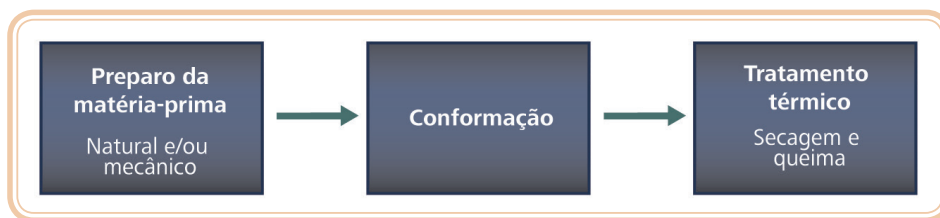
Figura 6.1: Diagrama esquemático do processo de fabricação do material cerâmico Fonte: Zandonadi, 1992
