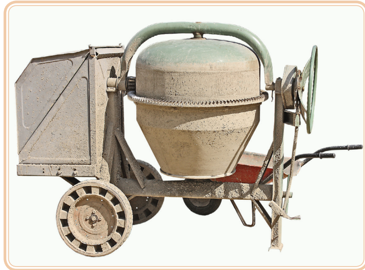
Figura 4.5: Betoneira de mistura por gravidade
