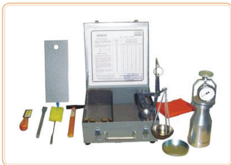
Figura 3.4: Equipamento Speedy Moisture Test para a medida do teor de umidade do agregado miúdo
