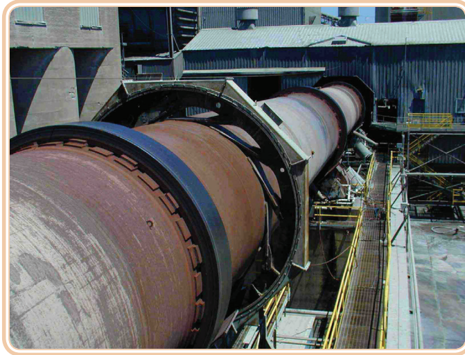
Figura 2.1: Forno rotativo para obtenção da cal virgem
