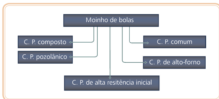
Figura 2.6: Tipos de cimento Portland após moagem nos teores de respectivas matérias-primas Fonte: CTISM, adaptado do autor
